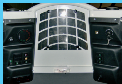
Driving place with pilot assisted joy-stick and tilting safety bar / Fahrerplatz mit Joystick, Sicherheitsstange / Место водителя с джойстиком и штангой сидения
