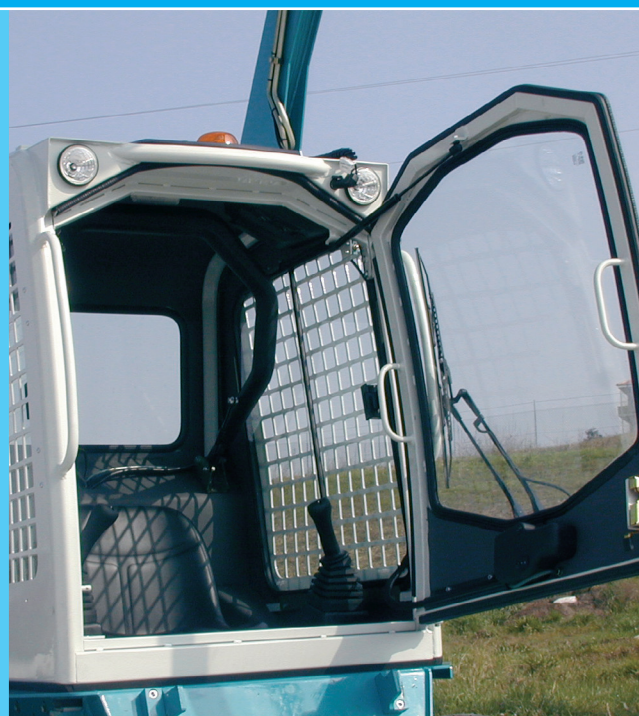
Cab with front door (optional), 1st or 2nd Stage FOPS, ROPS protection / Kabine mit Tür (Sonderzubehör), ROPS, FOPS 1st and 2nd Stage / Кабина с передней дверью (опция), ROPS, FOPS 1-го и 2-го уровня
